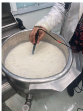
a) pH del producto. pH metro Vernier
