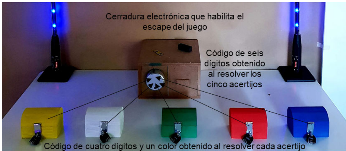
Figura 2. Sistema de códigos para cerradura electrónica que habilita el escape del juego.
