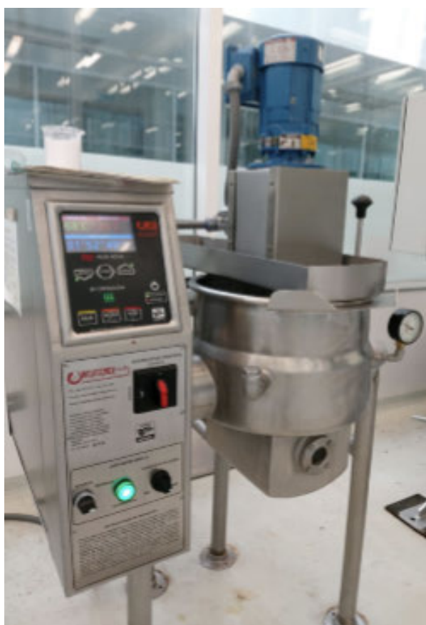
Figura 2. Marmita de calentamiento y agitación utilizada en el escalamiento del proceso (IntertecnicaMev-80 Marmita Eléctrica DeVolteo Industrial).
