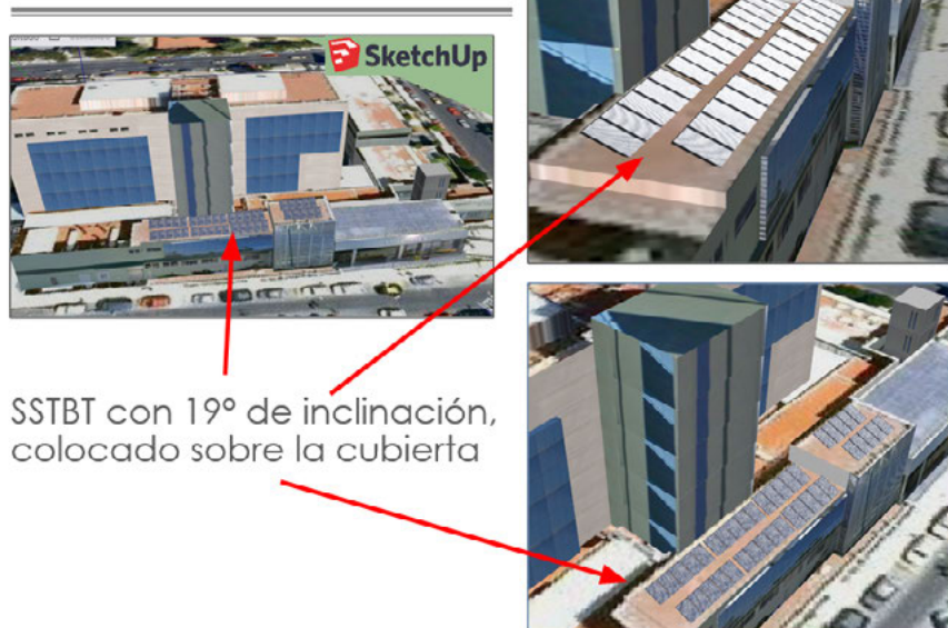
Figura 1. SSTBT diseñado para un hospital ubicado en el estado de Puebla. Este sistema lograría amortizar su costo en apenas 2.4 años y evitaría la emisión de 54.97 toneladas de CO 2 anuales. Una vez amortizado el proyecto, el hospital podría liberar $312,403.06 anuales de su presupuesto antes destinado al consumo de gas LP (Martínez et al., 2019).
